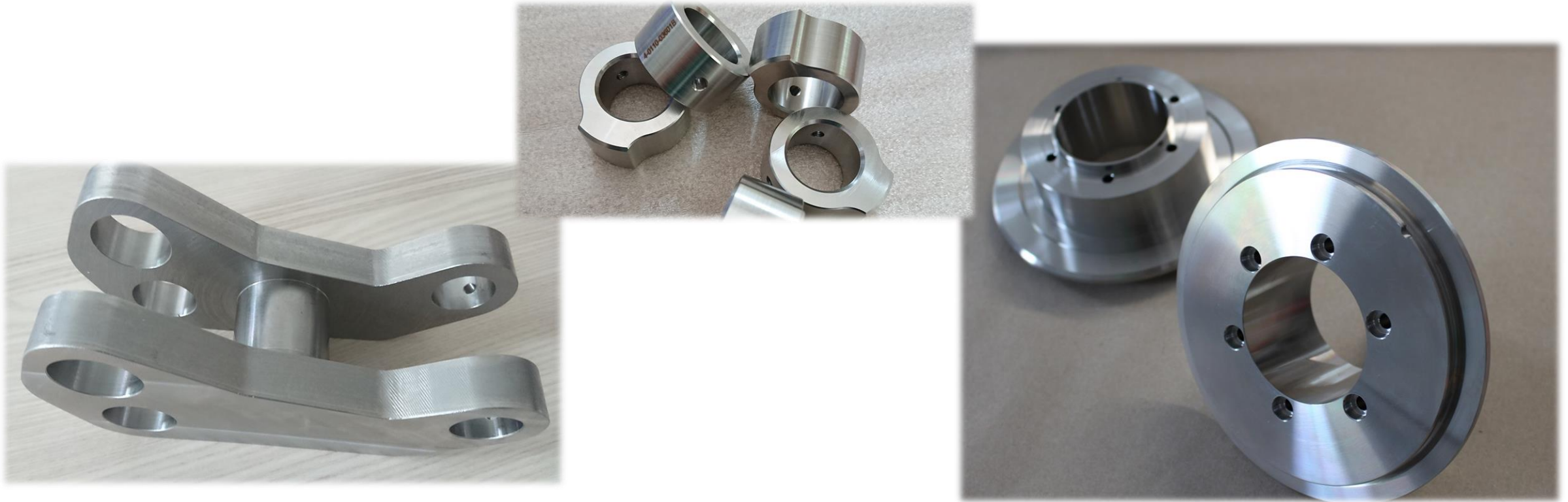
Kinematikhebel aus 42CrMo4 – auf CNC-Drehmaschine (mit angetriebenem Werkzeug) gefertigt
